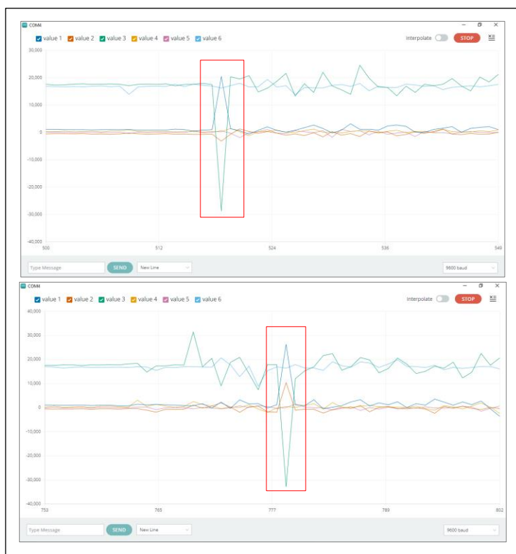
Figura 15. Ejemplo de gráficas de valores resultantes de los sensores y los picos de la aceleración provocada por el movimiento de la simulación de un sismo de subducción.
